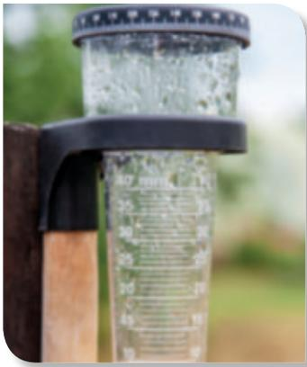
El pluviómetro es el instrumento que sirve para medir la lluvia que cae en un determinado lugar. La unidad de medida que se utiliza son los milímetros de altura.
