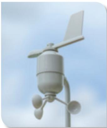
Con el anemómetro se mide el movimiento del aire y suele expresarse en kilómetros por hora.
