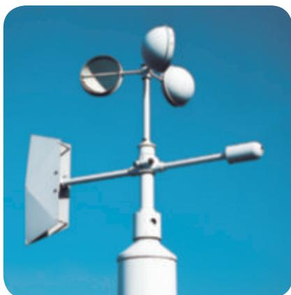
En un **anemómetro** debe haber unas cazoletas que midan la intensidad del viento y una veleta que determine su dirección. La velocidad del viento es una magnitud **vectorial**.
