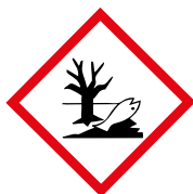
Peligroso para el medioambiente
